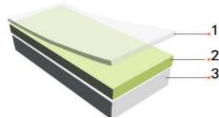
1.Transparent protective layer 2.Emitting layer 3.White bottom layer
